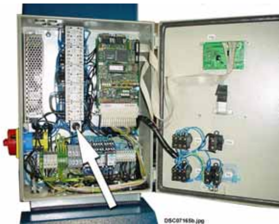
fig 2: Position du bouton poussoir de chintage
