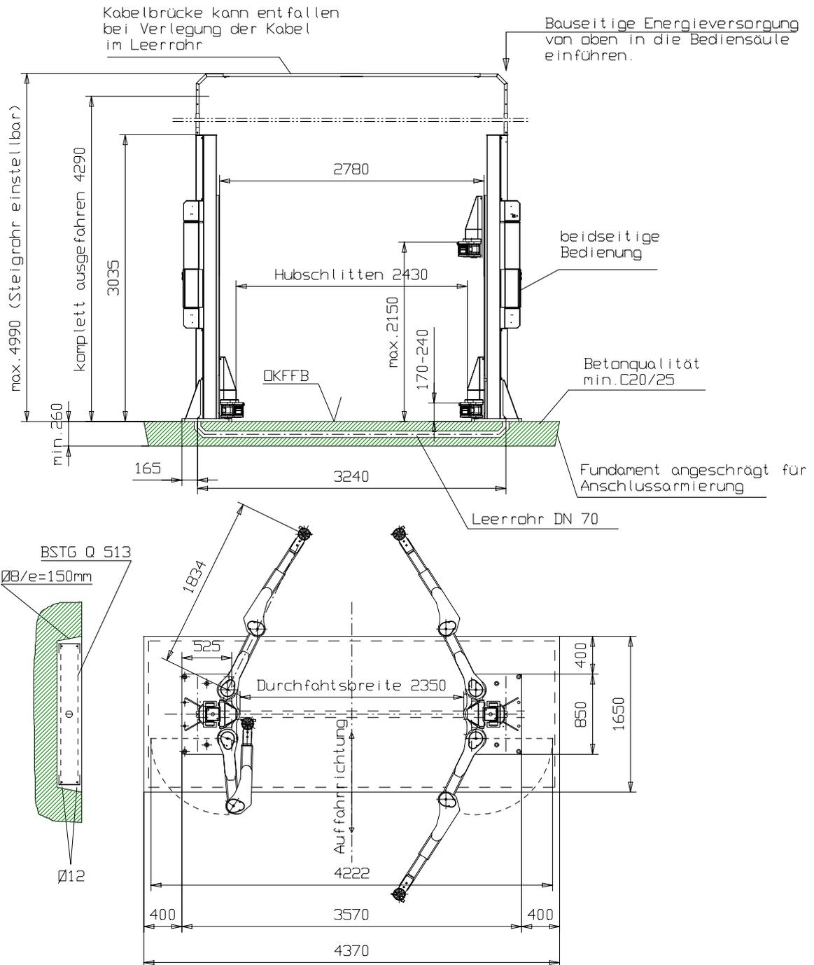
Bewehrung in beide Richtungen an Ober- und Unterseite der Fundamentplatte min. 3.5cm<sup>2</sup>/m (z.B. Baustahlgewebe Q513) umlaufend ØB/e=150mm in den Ecken längs jeweils Ø12
